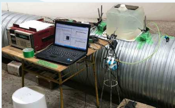
エアチューブの性能確認試験
