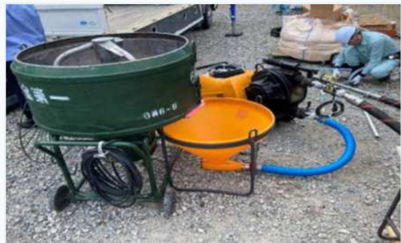
ESCON注入用機材
